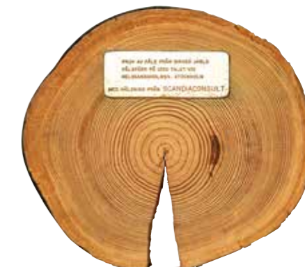
Tvårsnitt från ett prov av påle från Birger Jarls pålspar från 1250-talet. Det helt friska träet har spruckit då det torkat ut, det efter mer än 700 år i marken.
