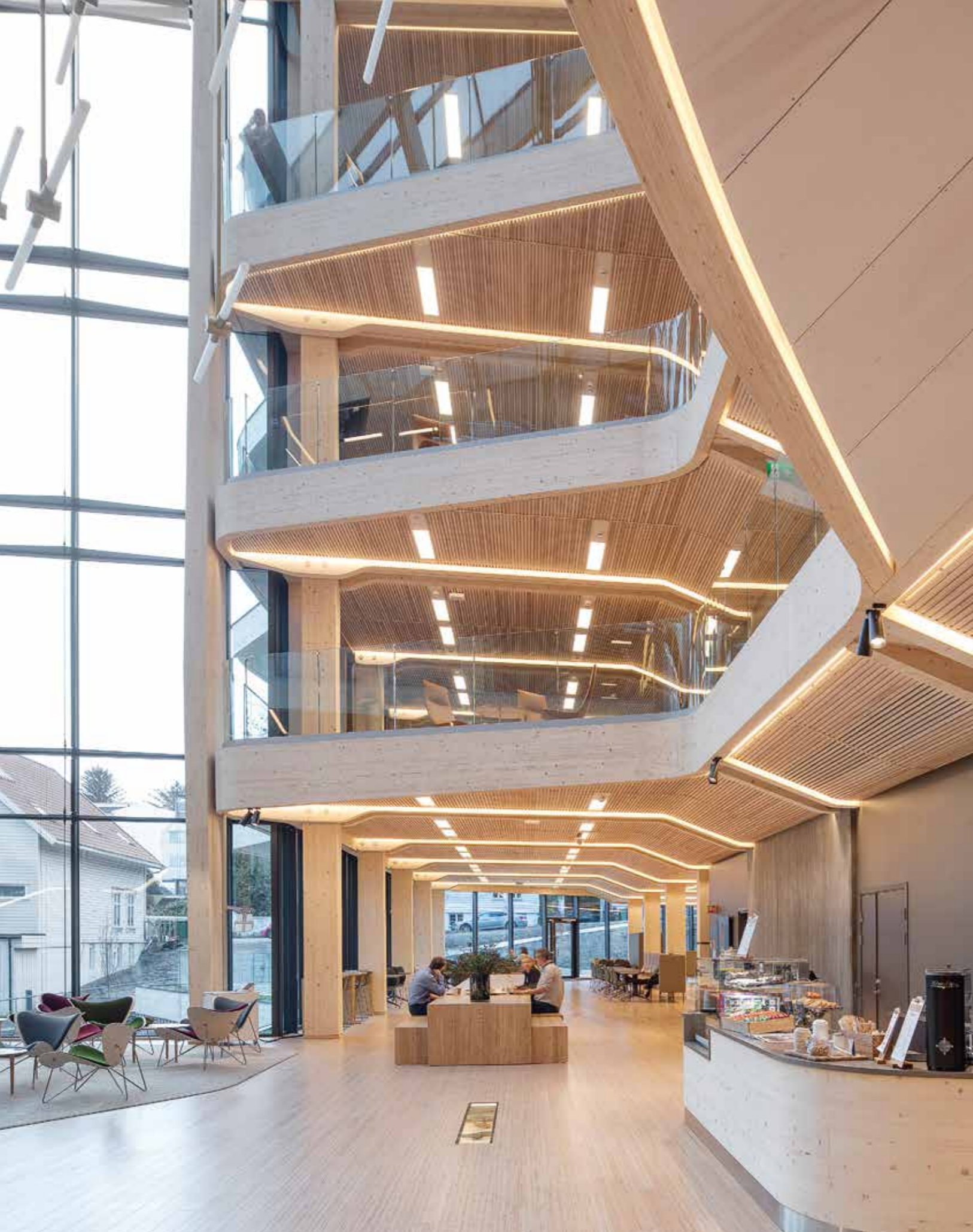
Arkitekterna har med pelar-balkstommen kunnat skapa en smäcker byggnad med stora öppna ytor.
