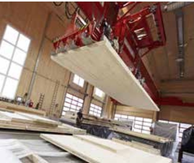
Hantering av KL-träskivor hos tillverkaren.
