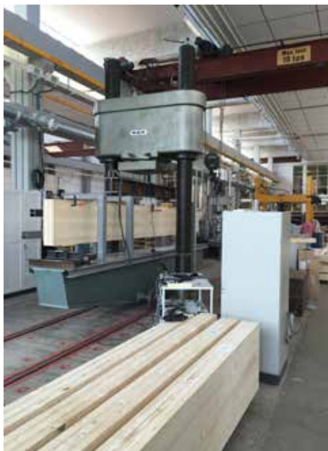
Hållfasthetsprovning av KL-trä.
