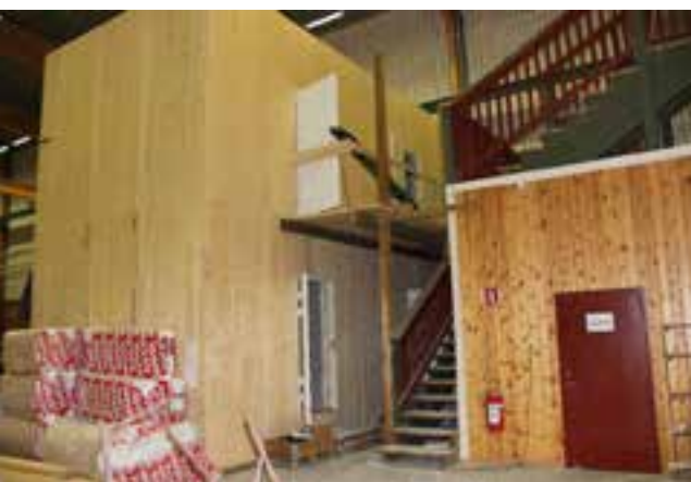
Utformning av ett testhus avsett för ljudmätningar.
