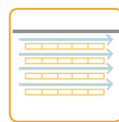
Strörlägg KL-träet om det blivit fuktigt
