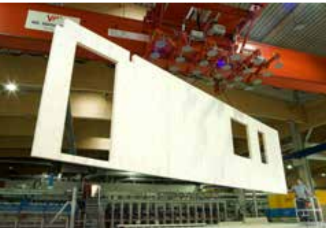
Produktion av KL-trä till väggelement.
