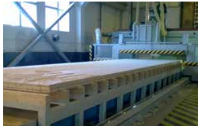
Bearbetning av KL-träskiva i CNC-maskin, Computer Numerical Control.
