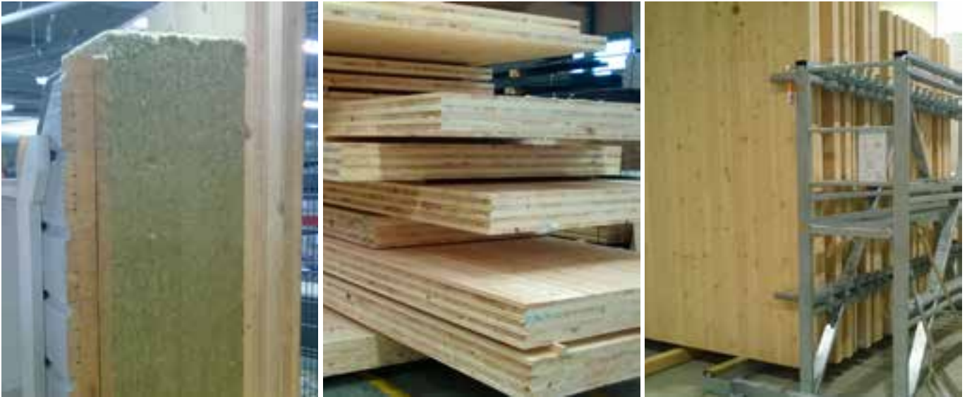
Tvärsnitt genom vägg med bärande KL-träskiva.
