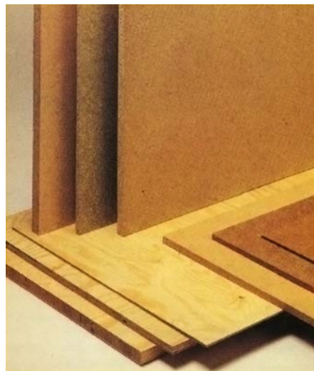
Olika typer av träskivor: Fiberskivor (wallboard), spånskivor, plywood.
