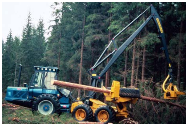
Träteck studerade skördare, som fäller, kvistar och apterar träd till stockar.
