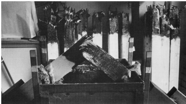
En tidig brandugn på Trätec på 1980-talet där virkeskvalitetens inverkan på förkolningen studerades av bland andra Joakim Norén.
