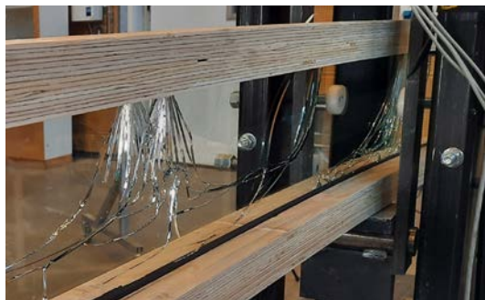
I-balkar med flänsar av trä och liv av glas har provats vid Linnéuniversitetet i Växjö. De har hög bärförmåga, tack vare träets förmåga att armera glaset, på samma sätt som ståls förmåga att armera betong. FOTO: LINNÉUNIVERSITETET
