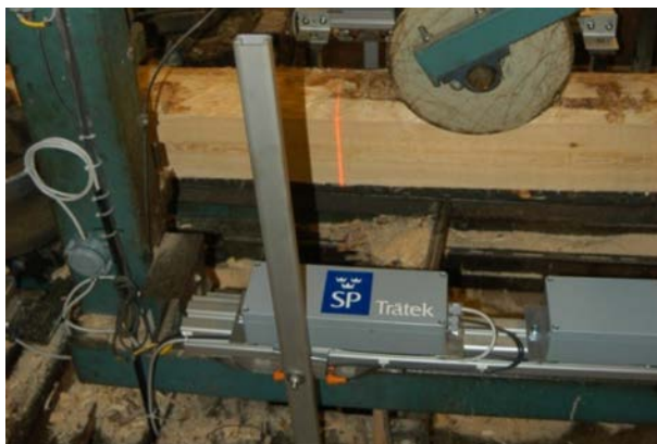
Trätec utvecklade mätutrustning för att mäta fibervinkel med hjälp av laser för att öka andelen rakt virke.
