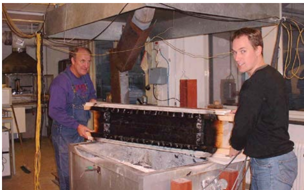
Brandprov i Träteks modellugn med Bo Edberg och Daniel Rydholm för att utveckla modeller för brandteknisk dimensionering av träkonstruktioner.
