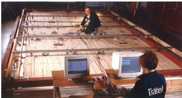
Massivträbjälklag utvecklades i Skellefteå på 1980-talet och blev inkörsporten till arbetet med träbroar. Per-Anders Fjellström i Skellefteå mäter deras egenskaper.
