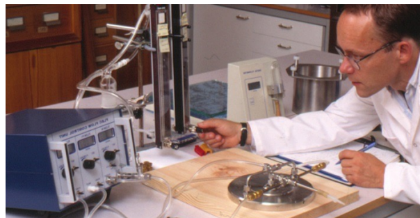
Finn Englund mäter emissioner från byggnadsmaterial med FLEC-metoden. Det fanns farhågor att terpenener från trä kunde vara farliga, vilket kunde avfärdas med hjälp av internationell expertis.
