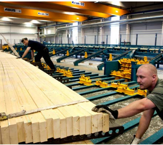
Tillverkning av krökt limträelement.
