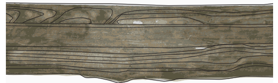
Figur 16.2 Limträbalk utan betydande diskontinuitet efter brand.
