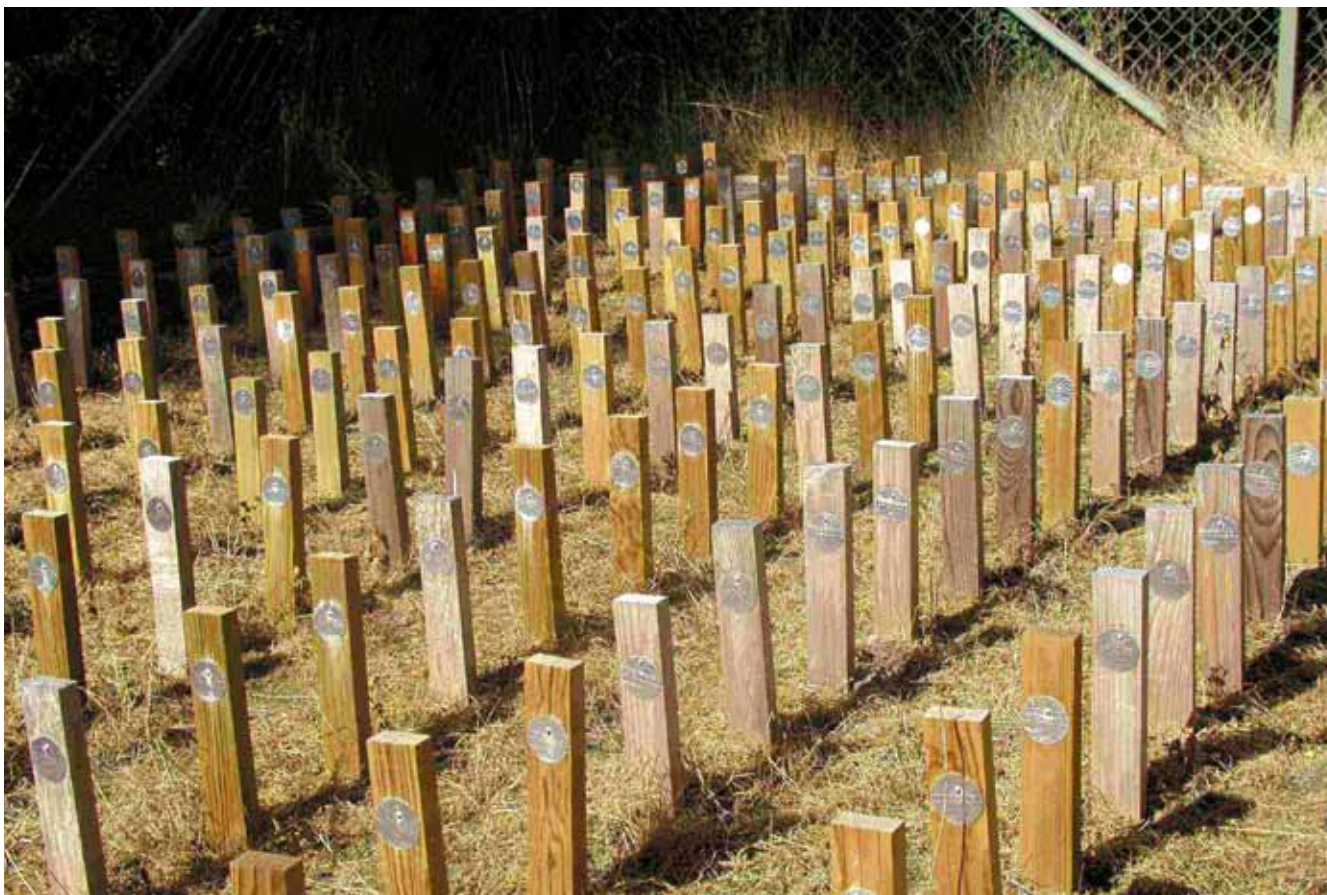
Markprovning enligt EN 252 på SP:s provfält i Borås. Stavarnas dimension är 25 x 50 x 500 mm.
