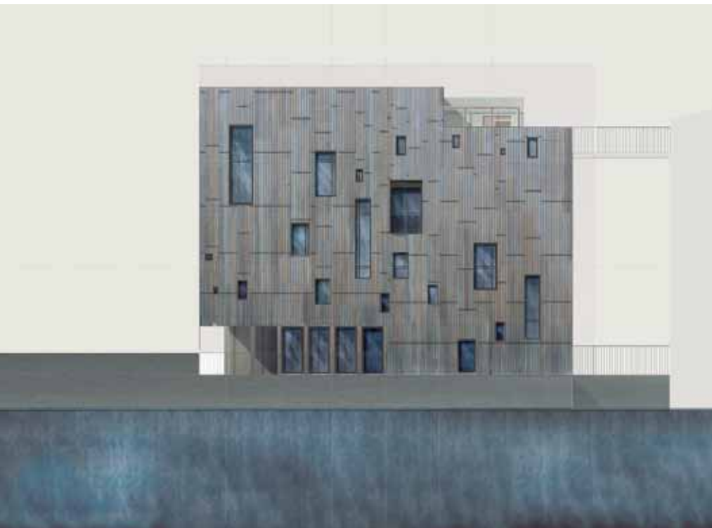
Fasad samt modellbild av interiör av ovanstående fritidshem. Husets betongkärna är i princip fristående från ytterväggarna, vilket tillåter en friare fönsterplacering, till synes oberoende av husets inre struktur. Av Anna Englov.
