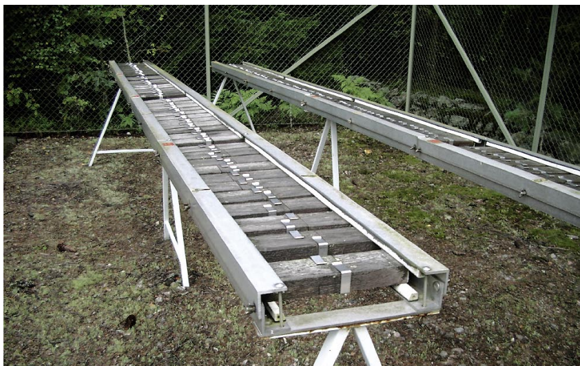
Ovan mark-provning enligt Lap-jointmetoden.
