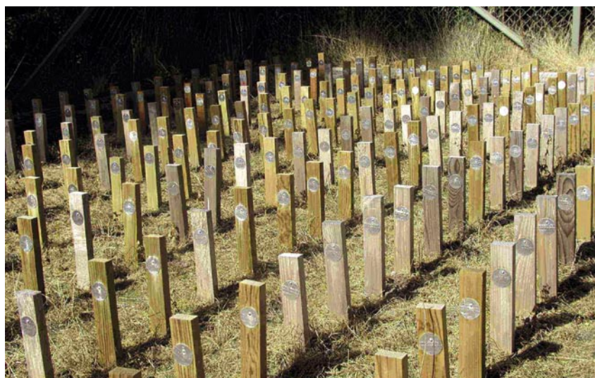
Markprovning enligt EN252 på SPs provfält i Borås.
