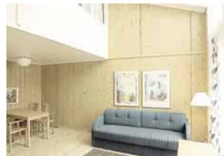
Sprinkler medger användning av trä som invändigt ytmaterial. Interiör från Vetenskapsstaden i Stockholm.
