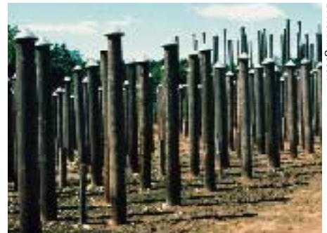
Stolpodlingen i Simlångsdalen. Det forskas på rötangrepp i dessa stolpar.
