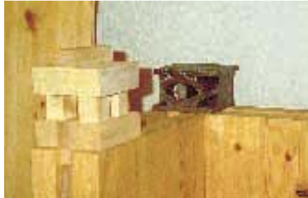
Ljudspärr av hårdpressad asp och ljudspärr i form av rullager i stål.
