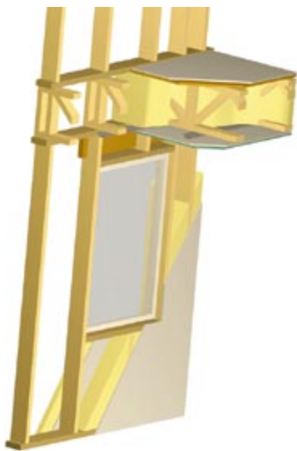
Figur 6. Bjälklag upplagt på våningshöga väggar.
