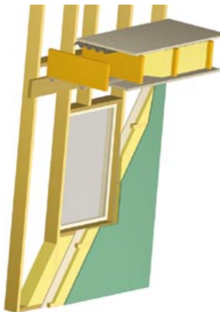
Figur 5. Kontinuerliga väggreglar med inhängda bjälklag.
