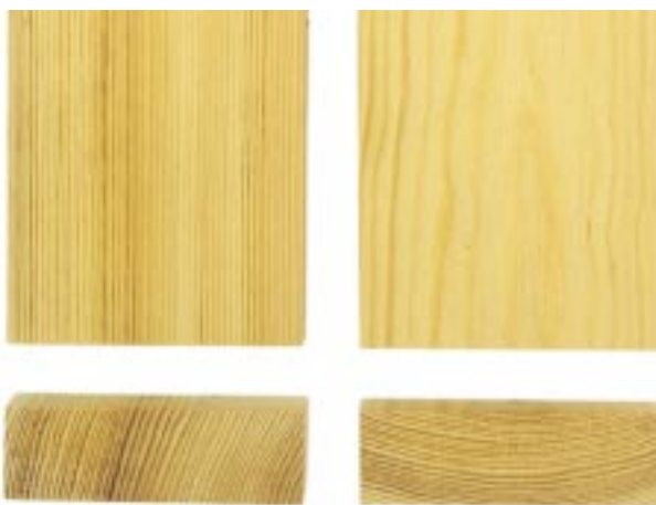
Vänstra bilden visar stående årsringar – radiell yta, den högra bilden visar liggande årsringar – tangentiell yta.
